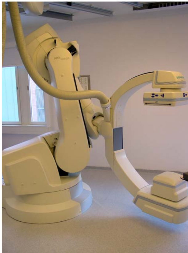
Angiografisk C-bue ved Rikshospitalets Intervensjonssenter (IVS), styrt av multiakse robot gir flere frihetsgrader og stor fleksibilitet (Siemens ZEEGO, 2008). Foto: dr. Per Kristian Hol, IVS.
