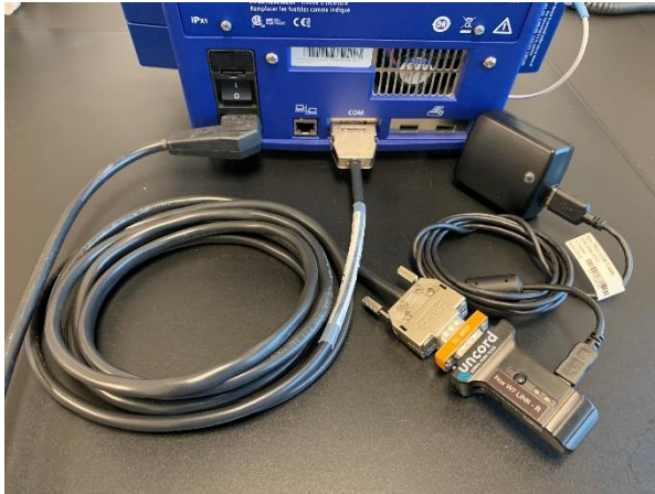
TCM 4 TOSCA koblet med Nox W7 Link – R. Sett i strømledningene. Still inn Tosca.
