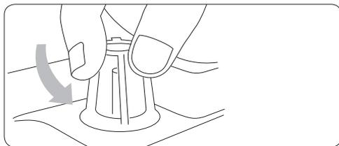
**17** Så snart filteret er misfarget og grått, skrues plasthetten av og det gamle filteret fjernes. Sett i et nytt filter og skru deretter hetten på plass igjen.
