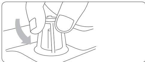
**17** Filteret udskiftes ved at skruer plasthætten af, tage det snavsede filter ud og putte et nyt i. Skru så hætten på igen.
