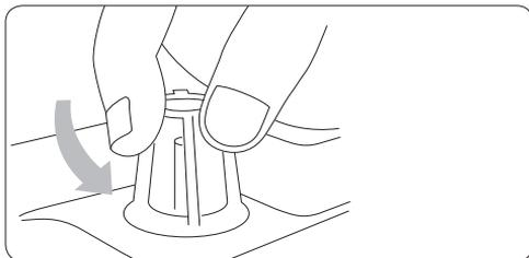
**17** Du byter filter genom att skruva loss plastskyddet, ta ut det gamla filtret och sätta in ett nytt. Skruva därefter på plastskyddet igen.
