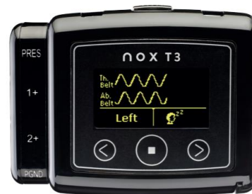
Bilde 5: Displayet viser signaler fra thorax og Abdomen, leie og snorking fra mikrofon.
