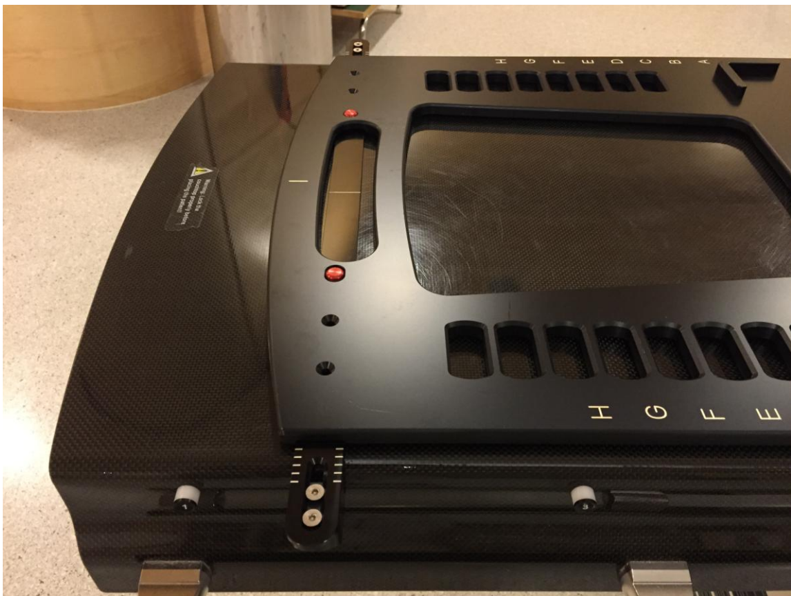
Figur 2: Baseplaten legges over hullene på lokbaren
